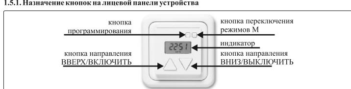
Рисунок 1. Расположение элементов управления и индикации
